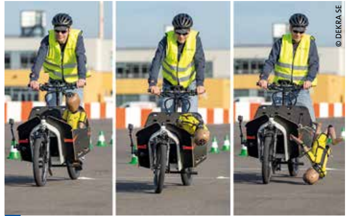
► Der nicht angeschnallte Kinder-Dummy wird bei der Bremsung aus 25 km/h aus dem Lastenfahrzeug geschleudert. Schwerste Kopfverletzungen wären die Folge.
